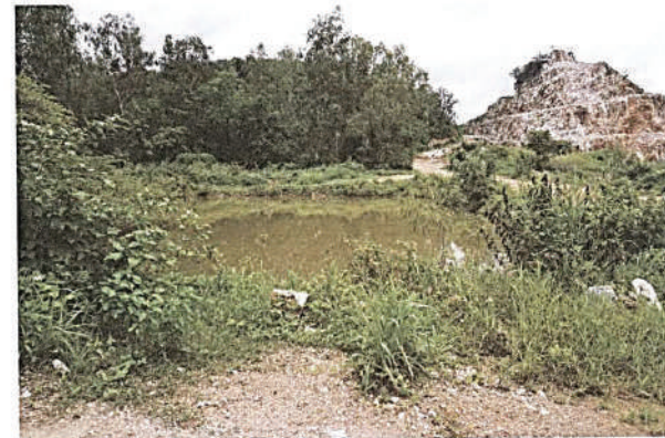
รูปที่ 6 แสดงบ่อคัดตะกอน รองรับน้ำฝนที่ไหลผ่านพื้นที่ทำเหมือง
