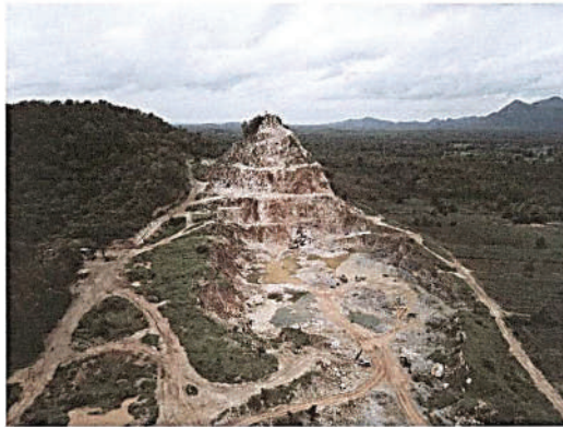
รูปที่ 1 แสดงสภาพพื้นที่หน้าเหมืองบริเวณด้านทิศตะวันออกของประทานบัตร เติมน้ำหน้าเหมืองไปทางทิศเหนือ มีการทำเหมืองเป็นแบบชันบันได
